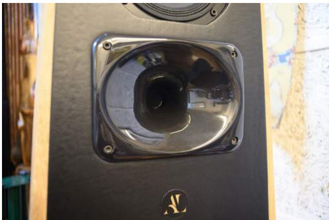
這是號角開口加上壓縮驅動高音單體的正統號角設計，單體採用 1 吋專利 Polypropylene 振膜，1.6kHz 以上的頻率響應非常平順，2kHz~16kHz 的聲波擴散均勻一致。
