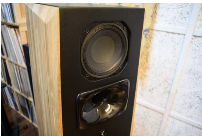
6 吋中音單體配備紙盆搭配布質折疊懸邊與強力釹磁鐵系統。
