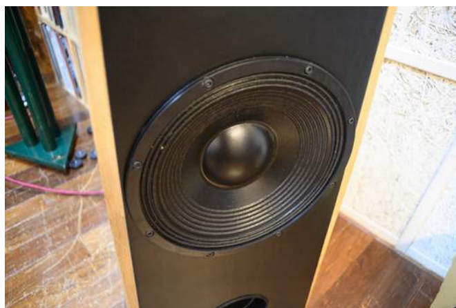
12 吋低音單體的紙盆混入了碳纖維，進一步提升振膜剛性。一般低音單體很少配備釹磁鐵，但是這顆單體因為散熱優異，所以配備了強力釹磁鐵，持續承受功率高達 1,200 瓦。
