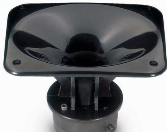
號角開口採用 Polypropylene 鑄造，結構紮實的補強框架可以排除號角本身的共振音染。
