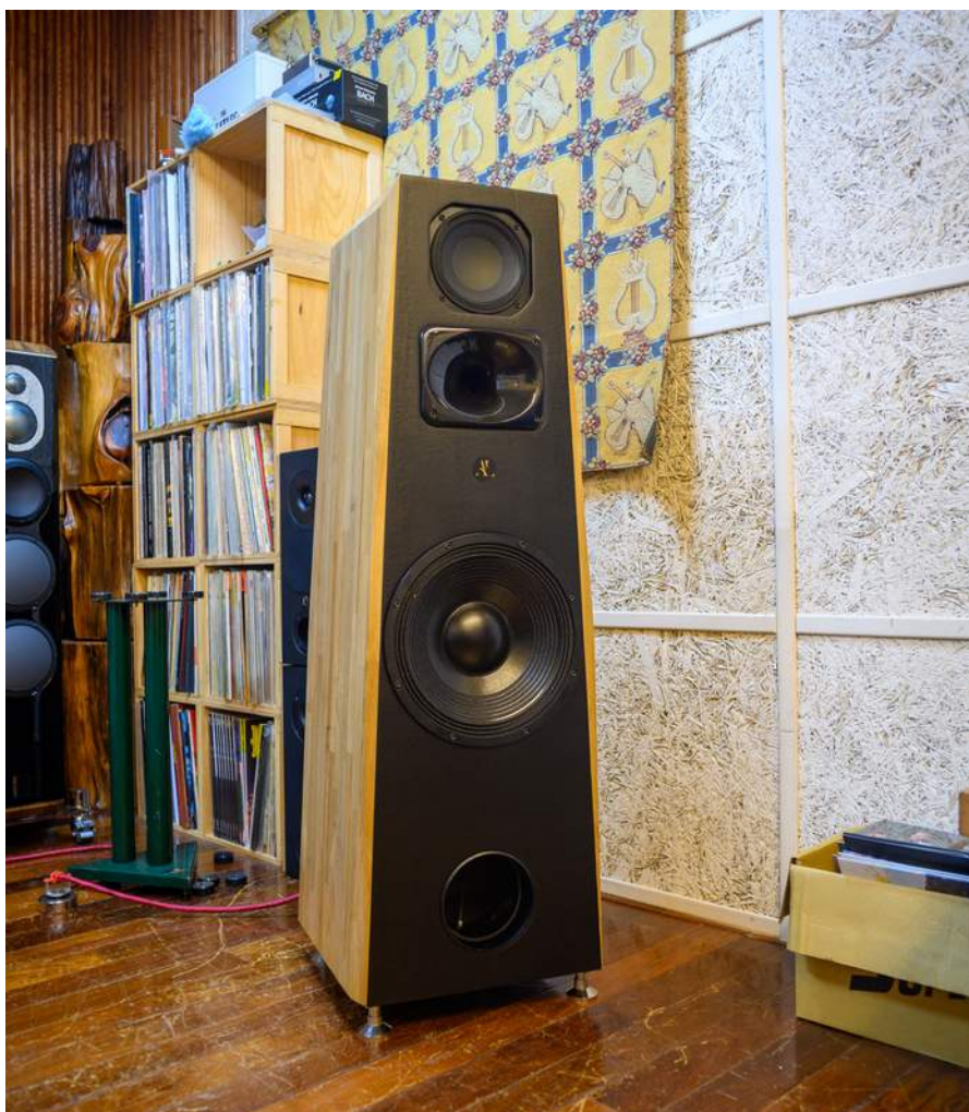
箱體是上窄下寬的梯形結構，可以藉由非平行面打散箱內駐波，兩側板是拼接橡木，可以藉由 MDF 加上實木的複合材料特性，降低箱體共振音染，單支喇叭重達 60 公斤。
